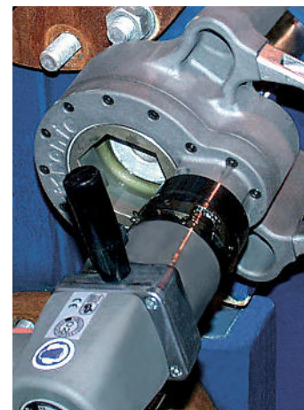
Bild oben: alkitronic® CLS-SG Schrauber bei Revisionsarbeiten an einem PWT. Bild unten: PWT von Alfa Laval
