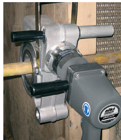
Bild oben: alkitronic® RCL Druckluftschrauber im Arbeitseinsatz an einem Plattenwärmetauscher (PWT). Bild unten: alkitronic® CLV-R
