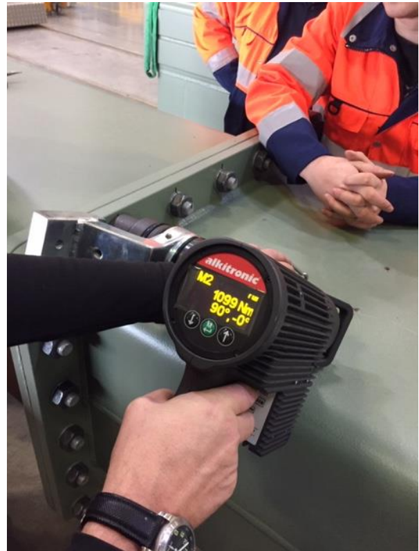
Abbildung 3: Verschrauben nach dem Drehmoment-/Drehwinkelverfahren
