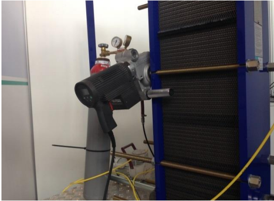
Abbildung 1: Der alkitronic EFCip-R an einem Plattenwärmetauscher. Foto: alki TECHNIK
