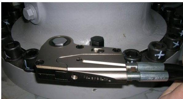
Abbildung 7: alkitronic® Hydraulik - Drehmomentschrauber AX-1 bis 750Nm am Azimutantrieb
