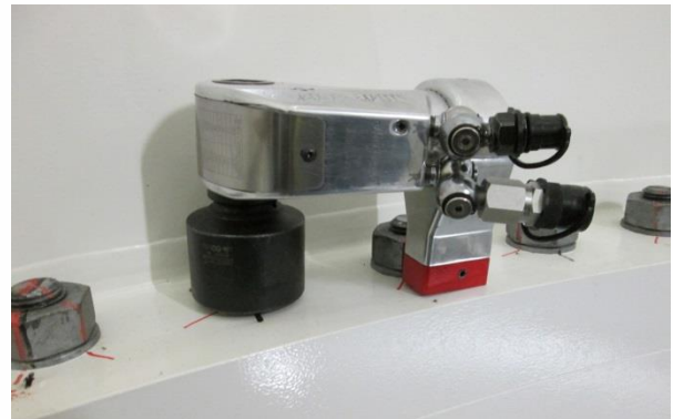
Abbildung 4: alkitronic® Hydraulik-Drehmomentschrauber AS-3 an Turmflanschschauben M36-HV
