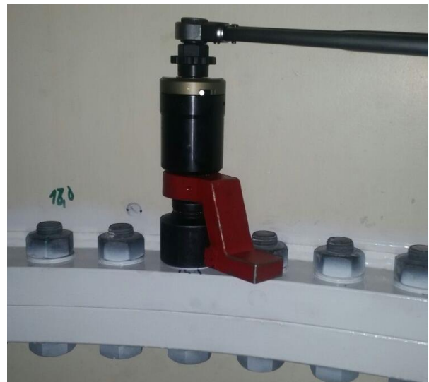
Abbildung 8: alkitronic® Handkraftschrauber HG 20 an Turmschrauben M36-HV
