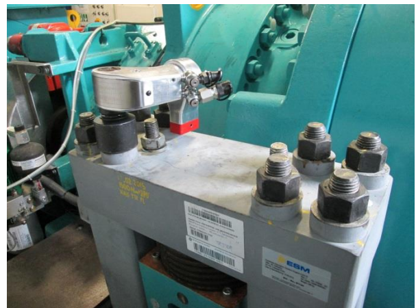
Abbildung 3: Hydraulikschrauber AS-3 an einem Stehlager
