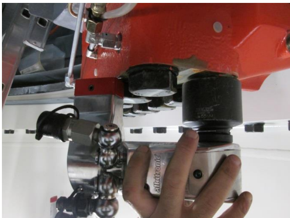
Abbildung 2: alkitronic® AS-3 an einer Azimutbremse über Kopf
