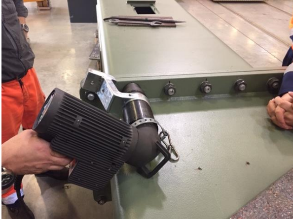
Illustration 2: La forme angulaire de l'alkitronic® ECWip facilite le vissage sur les portiques.
