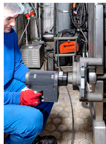
Bild oben: alkitronic® EFCip-SG Schrauber bei Revisionsarbeiten an einem PWT. Bild unten: PWT von Alfa Laval
